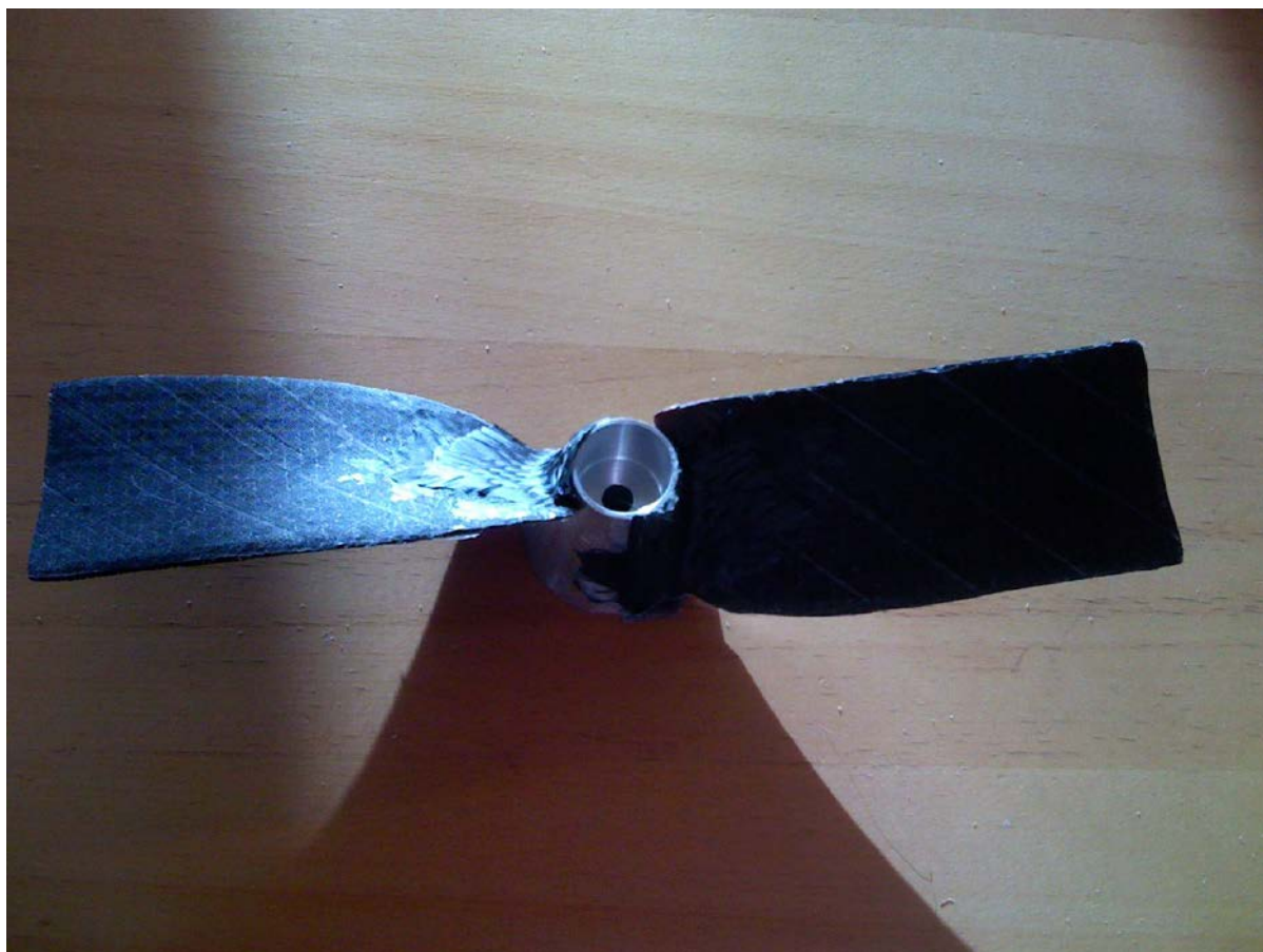
Figur 3 Propellerblad fixerade med kolfiberväv
