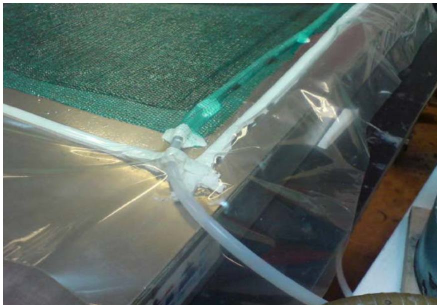
Figur 1. På vakuumbordet placeras fibrerna och sedan läggs ett lager releaseväv (syns ej på bilden) som täcks av ett par lager distributionsväv (det gröna i bilden). Ovanpå detta läggs ett lager plast som fästs med tacky-tape. Inloppet syns i bilden och fästs även det med tacky-tape för att sluta tätt.
