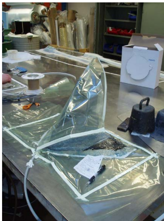
Figur 11 Vakuuminjicering av aktre bärplan med stabiliseringsvinge
