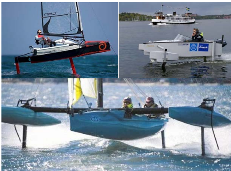
Figur 3. Skrovformer på andra vattenfarkoster med bärplanslösning.
