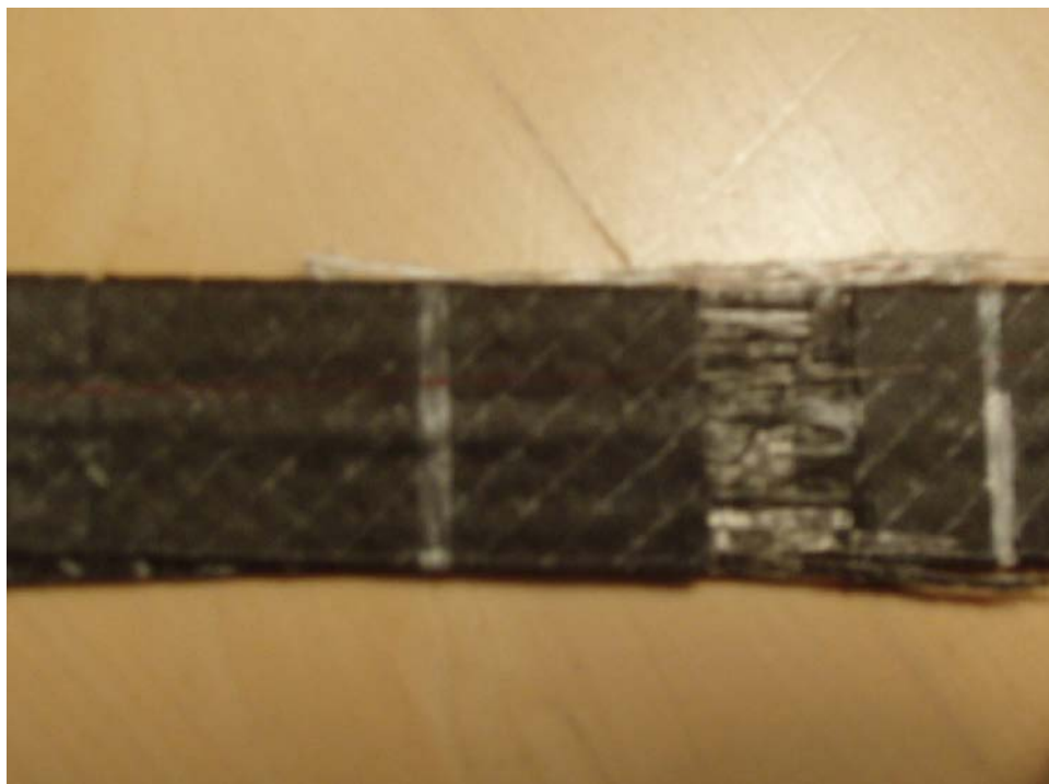
Figur 2. Typisk brott vid dragprovet.
